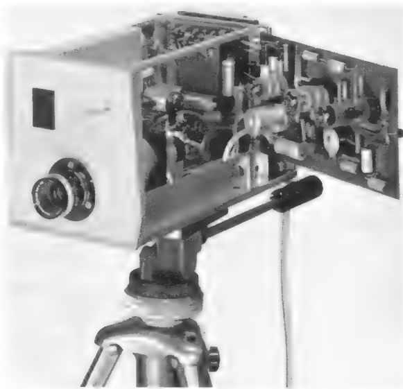
Links: Bild 1. Der Bausatz für die Fernseh-Kompakt-Kamera von Carman, Wiesbaden
