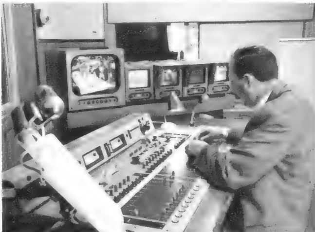
Bild 1. Der Toningenieur am Mischpult im Studio Hamburg. Im Hintergrund links der Monitor für das abgehende (aufzuzeichnende) Bild, rechts daneben Vorschau-Monitore
