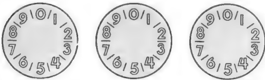
Bild 130. Dreistellige Anzeige mit drei Röhren ZM 1050; angezeigt wird die Zahl 752
